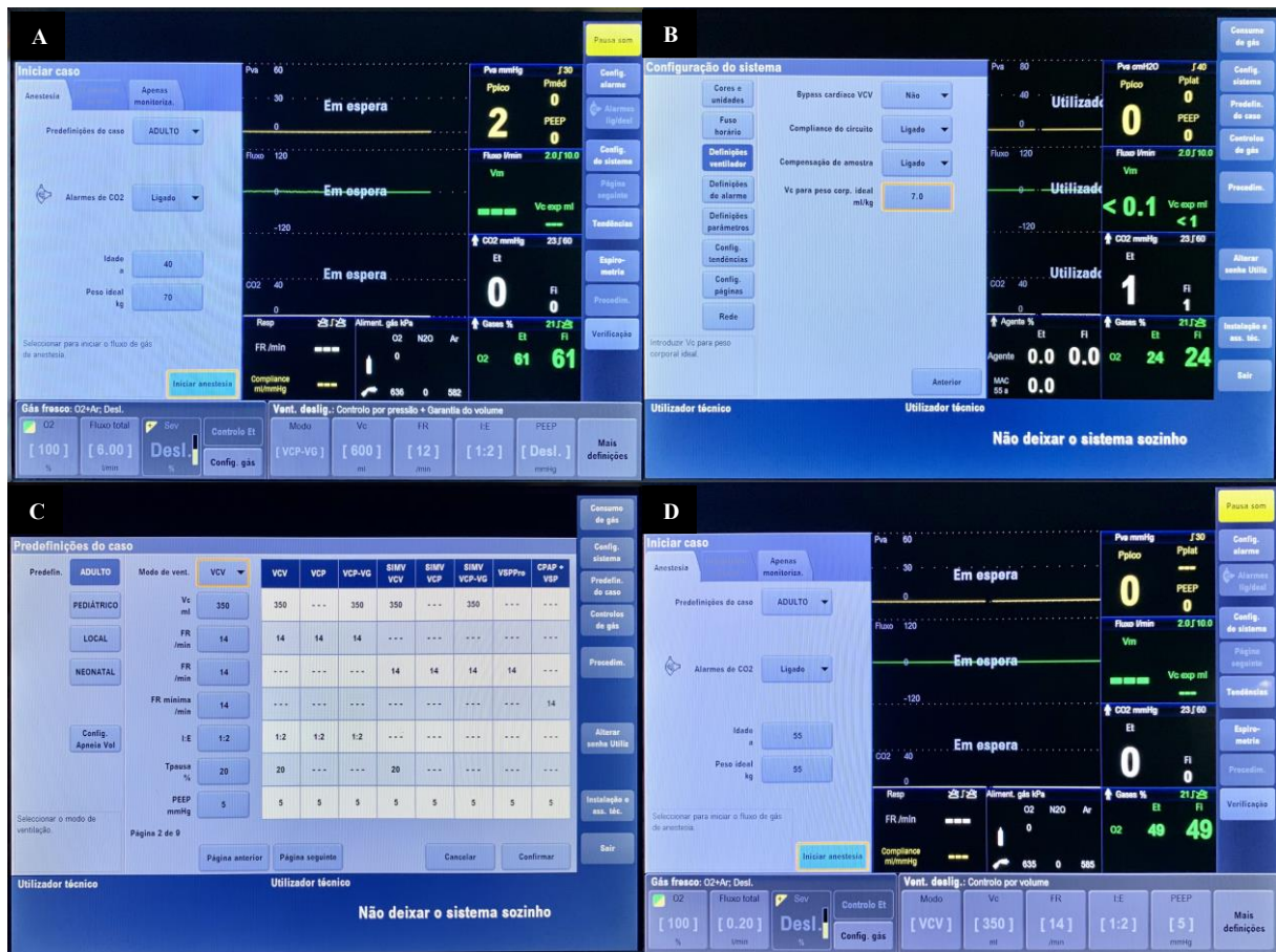
Figura 12. Processo de reprogramação do aparelho de anestesia GE Datex-Ohmeda Aisys CS 2 .
