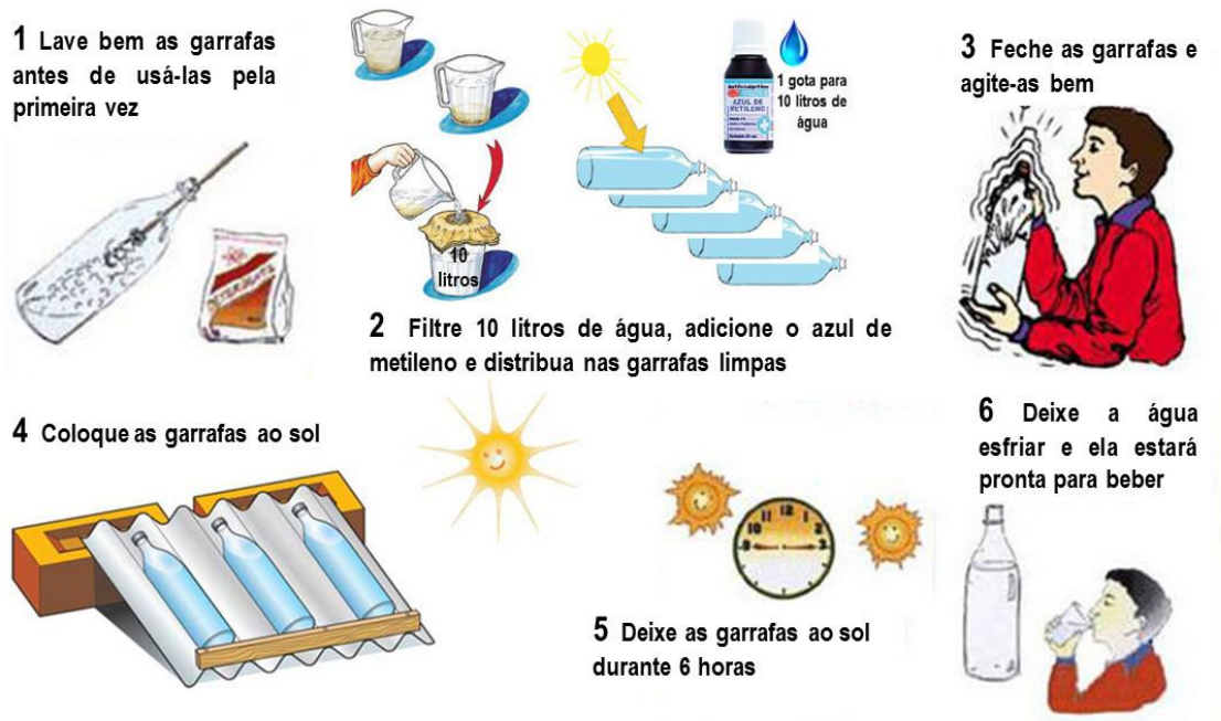
Figura 37 – Esquema proposto para o uso doméstico do AM na técnica SODIS para 10 litros de água
