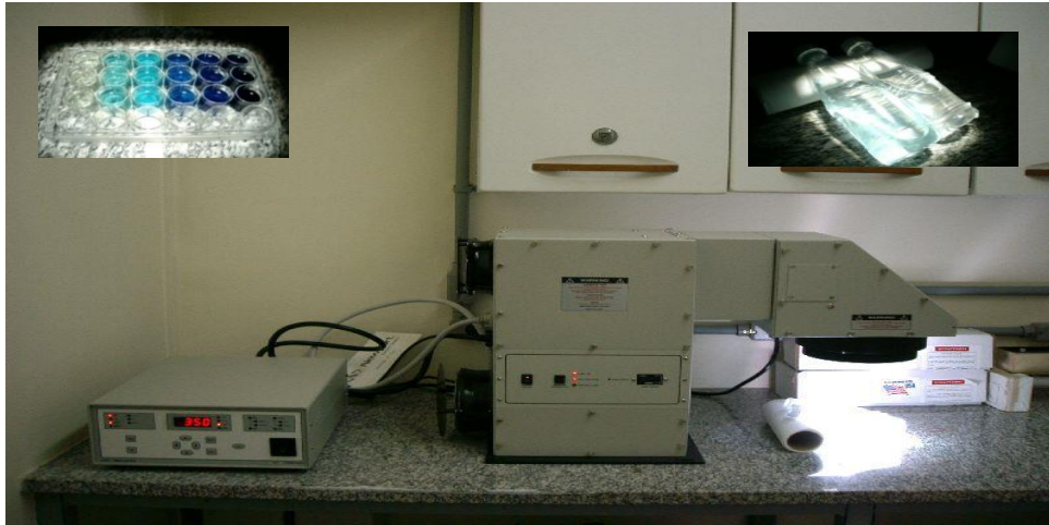
Figura 11 - Fotografia do simulador solar ORIEL. Placas de 24 poços e garrafas PET de 300 mL posicionadas sob a luz solar artificial no momento da irradiação
