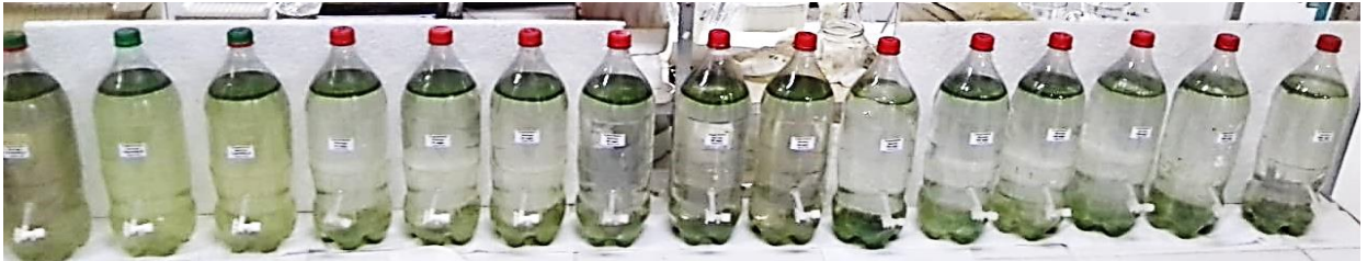
Experimento com sementes de Moringa oleifera para remoção de turbidez e células de cianobactérias.
