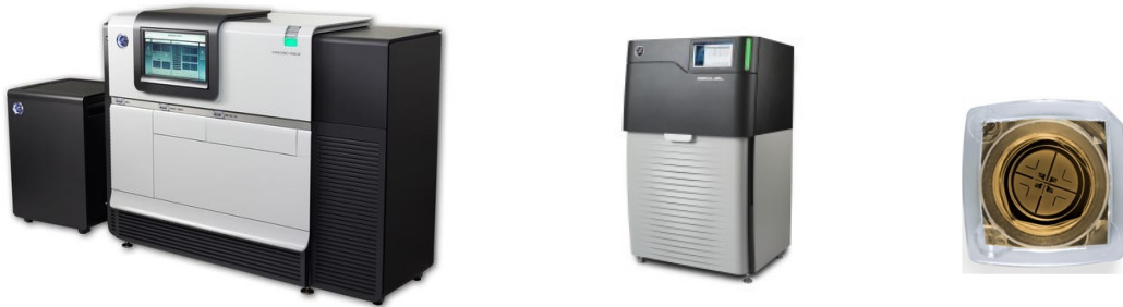
Figura 09: Fotografia dos TGS da Pacific Biosciences e do chip SMRT (à direita) onde ocorrem as reações de sequenciamento paralelo. À esquerda, o primeiro modelo, PacBio RSII. No centro, seu contemporâneo, o PacBio Sequel, que promete um volume maior de dados por corrida maior que seu antecessor em 7x.
