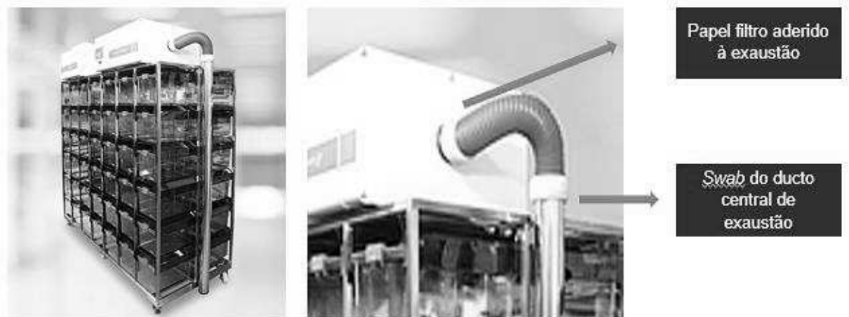
Figura 3. Ilustração representativa dos pontos de coleta de amostras em racks ventiladas. Fotos retiradas do catálogo de produtos da empresa Alesco Indústria e Comércio LTDA.
