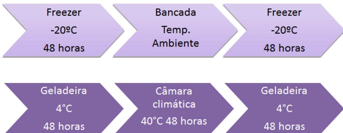
Figura 8. Representação gráfica do teste de estabilidade dinâmica das formulações submetidas a condições extremas na temperatura de armazenamento. Na linha superior, o ciclo de armazenamento foi congelamento-temperatura ambiente-congelamento; e na inferior, resfriamento-aquecimento moderado-resfriamento. A troca de uma temperatura para outra foi realizada a cada 48 horas, em um período de duas semanas (armazenamento forçado de curta duração).
