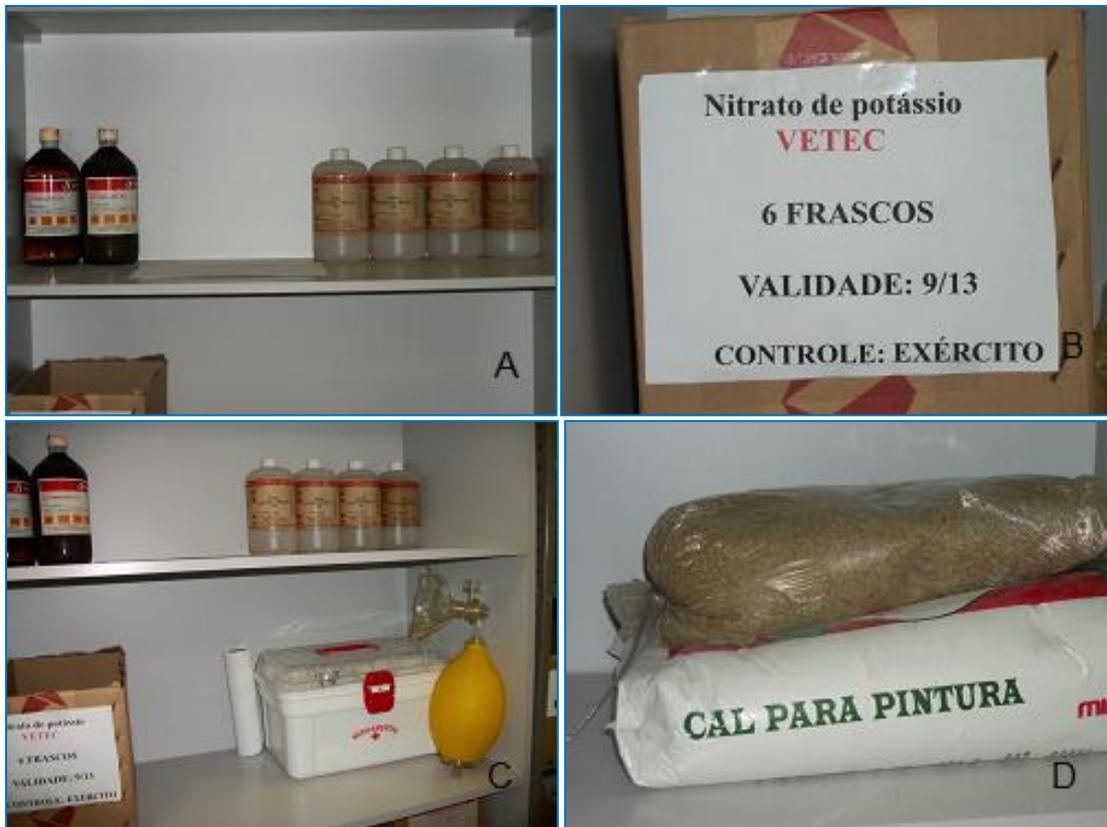
Figura 21: Imagens da sala após adequação às exigências do Exército para armazenamento de produtos químicos controlados. A) Frascos plásticos contendo ácido fluorídrico e frascos de ácido nítrico. B) Frascos de nitrato de potássio. C) Maleta de primeiros socorros e reanimador respiratório. D) Cal para neutralização de ácidos e areia.
