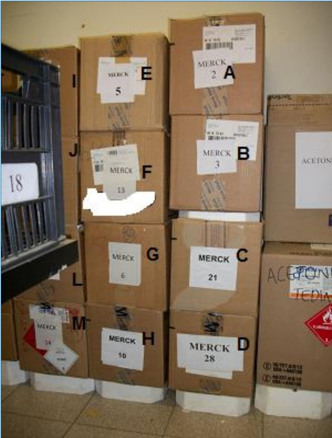
Figura 22: Imagens de armazenamento dos produtos químicos - caixas sem identificação externa do conteúdo. Conteúdo das caixas: A) Tolueno. B) Metanol. C) Etanol. D) Acetona. E) Metanol. F) Éter dietílico. G) Clorofórmio. H) Acetona. I) Etanol. J) Ácido clorídrico fumegante. L) Tolueno. M) Clorofórmio.
