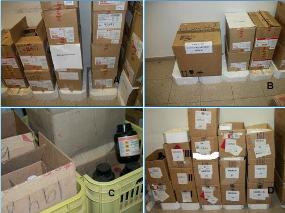
Figura 24: Caixas de produtos químicos na sala de armazenagem contendo produtos incompatíveis. A) Ácido acético ao lado de ácido nítrico. B) Hexano ao lado de ácido sulfúrico. C) Permanganato de potássio ao lado de ácido sulfúrico. D) I. Acetona. II. 2 frascos de éter dietílico, 2 frascos de entelan, 3 frascos de óleo de imersão e 1 frasco de álcool isopropílico. III. fosfato ácido de sódio.
