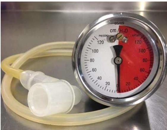
Figura 6: Manovacuômetro analógico utilizado para mensuração da Pimáx.
